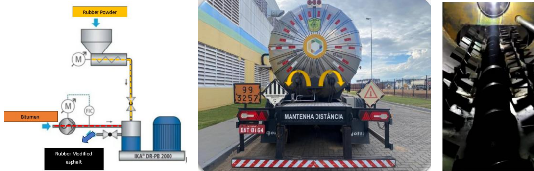
Figura 2. Agitación del asfalto en tanques de transporte (CBB, 2023)
